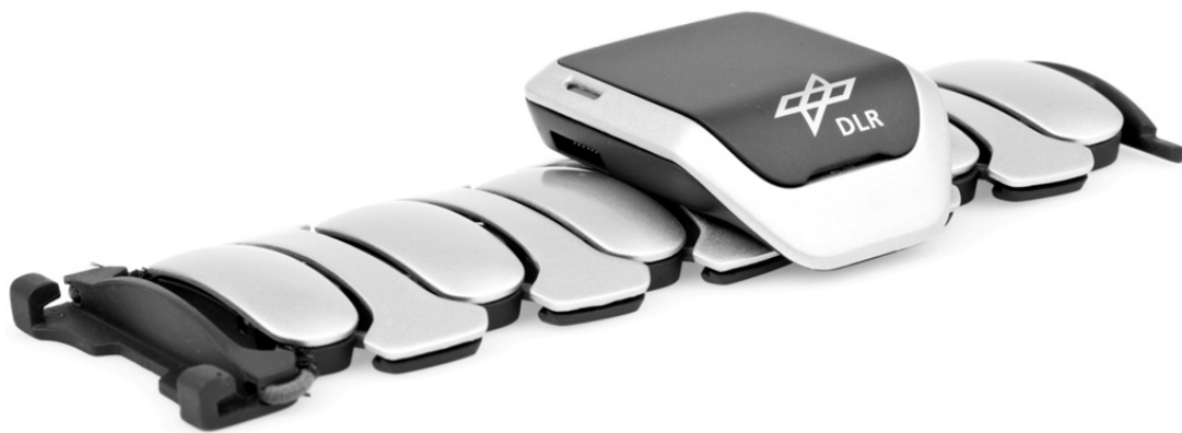
Bild 3: Das vibrotaktile Feedbacksystem VibroTac
